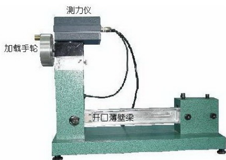
图 9-1 为开口薄壁梁实验装置，试验件为一悬臂开口薄壁梁
