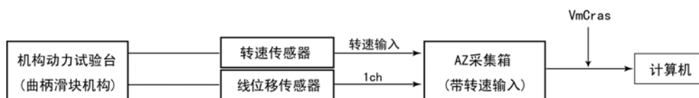
图 15-2a 曲柄转速及滑块线位移测量实验框图
