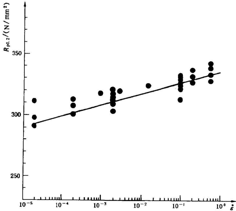
注： $\dot{\epsilon}$  = 塑性应变速率，单位为  $(\text{mm}/\text{mm}) \cdot \text{min}^{-1}$ 。
