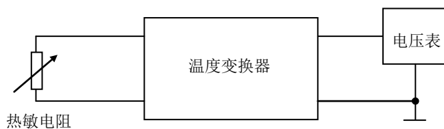
图 3.2 热敏电阻传感器接线图
