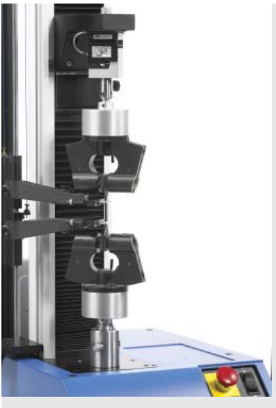
▲ ASTM D 412 橡胶哑铃形试样试验
